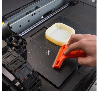
Figur 3: Prototyper af casing til ny sensorteknologi tages ud af 3D printeren.
